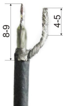
Рисунок 2 – Разделка кабеля соединительного
